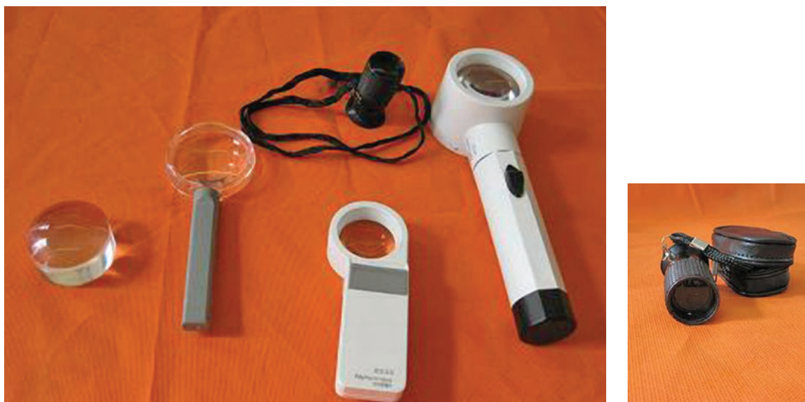
Figura 2 - Lupas Manuais e Telescópio. Exposição de quatro lupas de apoio e de mão e um telescópio.
