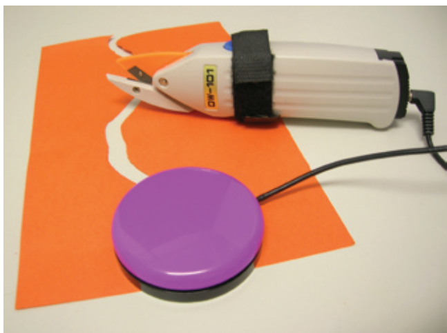
Figura 5 - Tesoura elétrica ativada por acionador.
