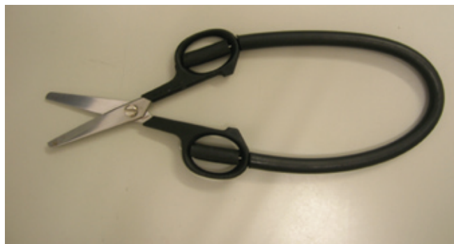
Figura 1 - Tesoura adaptada com arame revestido.
