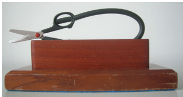
Figura 3 - Tesoura adaptada em suporte fixo.
